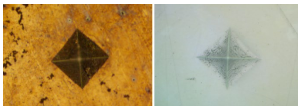
Рис.2. Пример различной контрастности для изображений отпечатков на разных материалах: слева – медь, справа – поликарбонат
